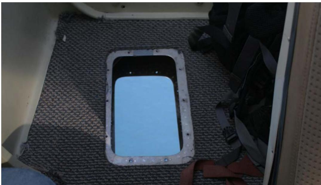
**Figura 4.** Vista de la ventanilla en el piso para la toma de fotografías aéreas verticales.
