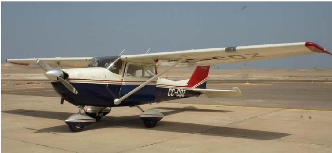
**Figura 3.** Avión monomotor Cessna 172 adaptado con una ventanilla en la parte inferior para la toma de fotografías aéreas verticales.
